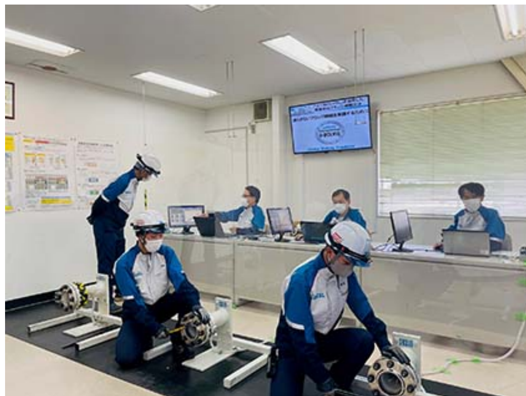
写真2 シミュレーターによる科学的なフランジ締付けトレーニング
