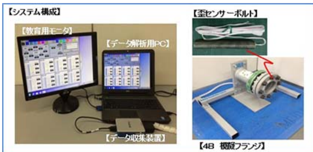
写真1 フランジボルト締付けシミュレーター (D-BOLVIS: Daicel Bolting Visualization)
